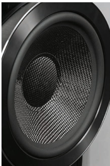
Membrany niskotonowe są bardzo sztywne, zarówno dzięki stosowanej już wcześniej strukturze „kanapkowej”, jak i wprowadzonemu teraz profilowi o zmiennej grubości. Z zewnątrz widać profil stożkowy (główniej części membrany), ale od tyłu membranę zamyka profil konkawy.
