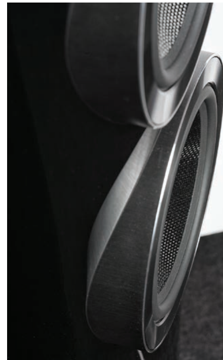
Głośniki niskotonowe są mocowane do aluminiowych cylindrów, które łączą się z aluminiowym wzmocnieniem wewnątrz obudowy.
