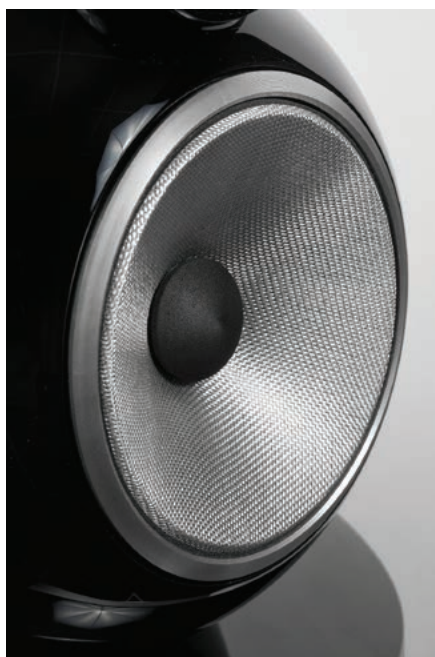
Umarł Kevlar... Niech żyje Continuum – też syntetyczna plecionka. Górne zawieszenie bez zmian – niskostratne FST, optymalne dla głośników średniononowych pracujących z niewielkimi amplitudami.
